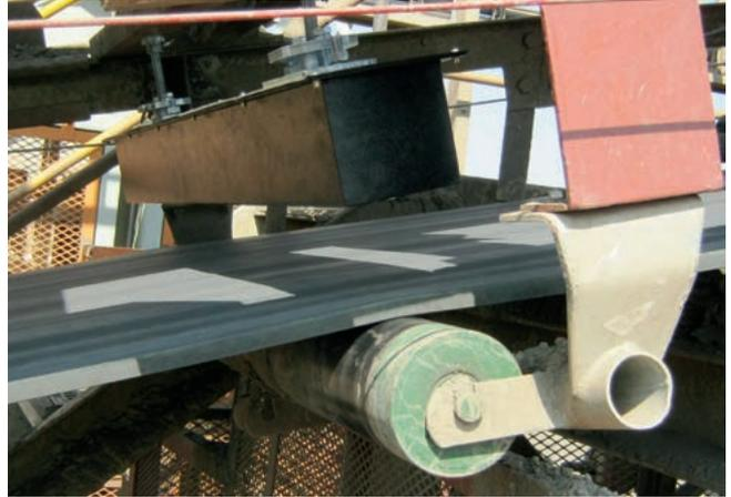
La disposición de sensor ultrasónico se completa con un rodillo de alivio
